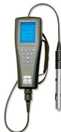
**Figura 6.8 – Sonda de monitoramento da qualidade da água em campo**
